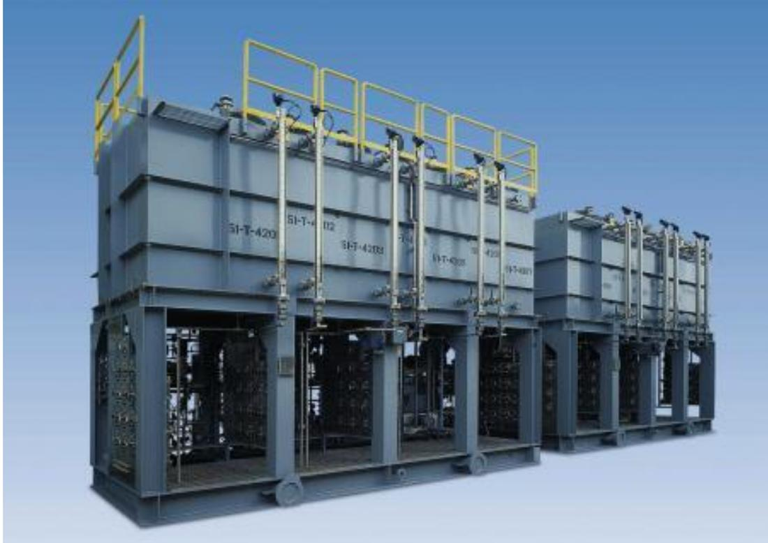
从活性药物成分(APIs)到气相缓蚀剂(VCIs)，可以将 1000 种添加剂和任何一种试剂注入到特定工业的工艺流中，以改变或赋予新的产品特性或加强加工动态。注入系统和化学撬系统提供了各种不同的剂量控制选项。整个过程需要液位检测和注入化学试剂的流量监测。
