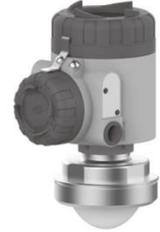
**工作原理** 80G 雷达物位计是采用调频连续波(FMCW)技术，通过天线发射高频的调频雷达信号，信号以光速在空间传播，遇到被测介质表面，其部分能量被反射回来，被天线接收。发射信号频率与接收信号频率的频率差与被测距离成正比，从而计算出天线到被测介质表面的距离。
