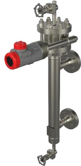
当介质含有蜡油时，易凝固，导致高温操作以及介质具有腐蚀性时，通博浮筒接液材料选用符合 NACE MR0103 标准的材质，表头加装隔热架或散热套（片）以消除高温介质对表头内电子元器件的不利影响。更好的保护整个装置可以长时间安全稳定运行。
