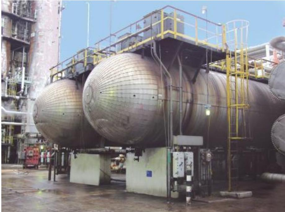
原油残留的盐水中包含的盐类会产生严重的腐蚀和结垢问题，必须予以去除。脱盐去除盐分和残留的游离水。尽管炼油厂是最经济的脱盐场所，但从保护管道角度考虑通常要求在采油现场进场脱盐处理。
